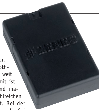
Dieses unscheinbare Kästchen sorgt für die beidseitige Kommunikation über den CAN-Bus
