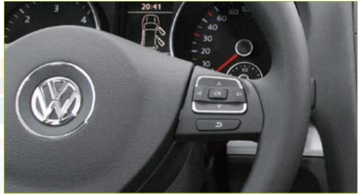
Komfort pur: Wenn das Auto ab Werk über Fernbedienungstasten am Lenkrad verfügt, kann der Fahrer diese dank CAN-Bus-Interface weiterhin benutzen.
