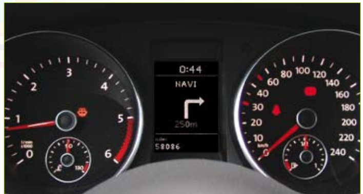
Voller Durchblick: Das Display zwischen Tacho und Drehzahlmesser wird vom E>GO mit Pfeilgrafiken, Titelnformationen oder Radio-Sendernamen versorgt.
