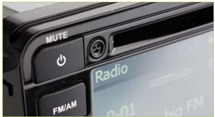
Alternative: Wer das mitgelieferte Mikrofon der Freisprecheinrichtung nicht extra einbauen möchte, kann auch das im ZE-NC2010 integrierte Mikro verwenden.
