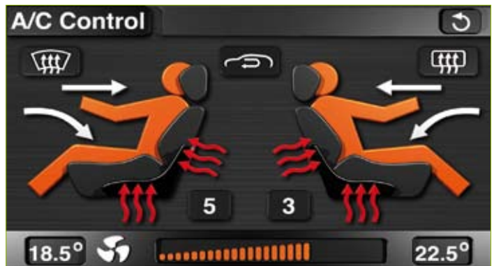
Schicke Lösung: Selbst die Daten der Klimaanlage werden vom CAN-Bus ausgelesen und schicken aufbereitet auf dem großen Touchscreen des ZE-NC2010 dargestellt.
